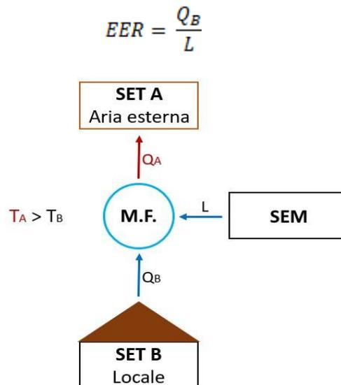
• **Pompa di calore** - il COP rappresenta il rapporto tra l'energia termica da fornire al SET a temperatura superiore e l'energia meccanica spesa:
